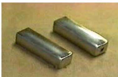
内圧による変形
