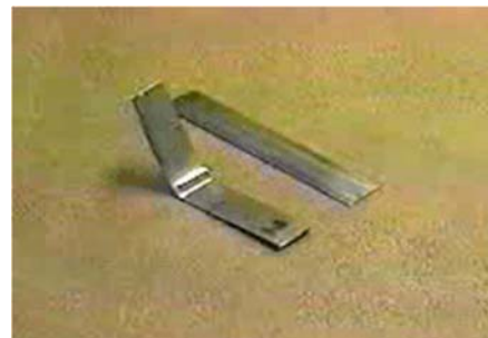
Fig.3 ケースからの切り出し材を用いた 3 点曲げ試験による材料定数の同定 (3)
