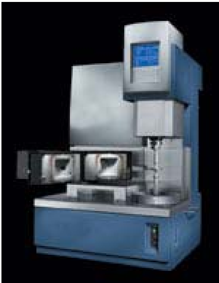
Fig.1 動的粘弾性試験装置 RSAIIIとその仕様 (1)
