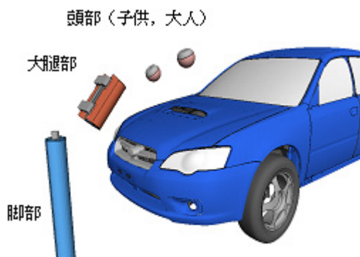
Fig.1 歩行者保護試験の概要 (欧州情報公開)
